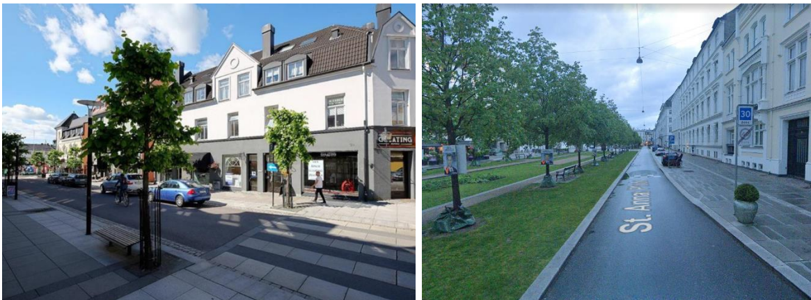
Figur 15: Til venstre, eksempel på oppstrammet veigeometri, parkering, møbleringssone og beplantning i Sandefjord (Civitas, 2020). Til høyre, eksempel på breie fortau, integrerte løsninger for korttidsparkering eller beplantning i København (Google Streetview, 2020).
